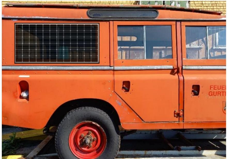
Abbildung 1: Seitenansicht Land Rover mit Solarpanel
